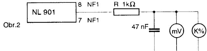
Pre obe normy (OIRT a CCIR) kontrolovať úrovne výstupných detektovaných nf signálov NF1 a NF2, ktoré musia byť min. 200 mV, skreslenie max. 1,5 %, rozdiel úrovní NF1 a NF2 max. 1 dB.
