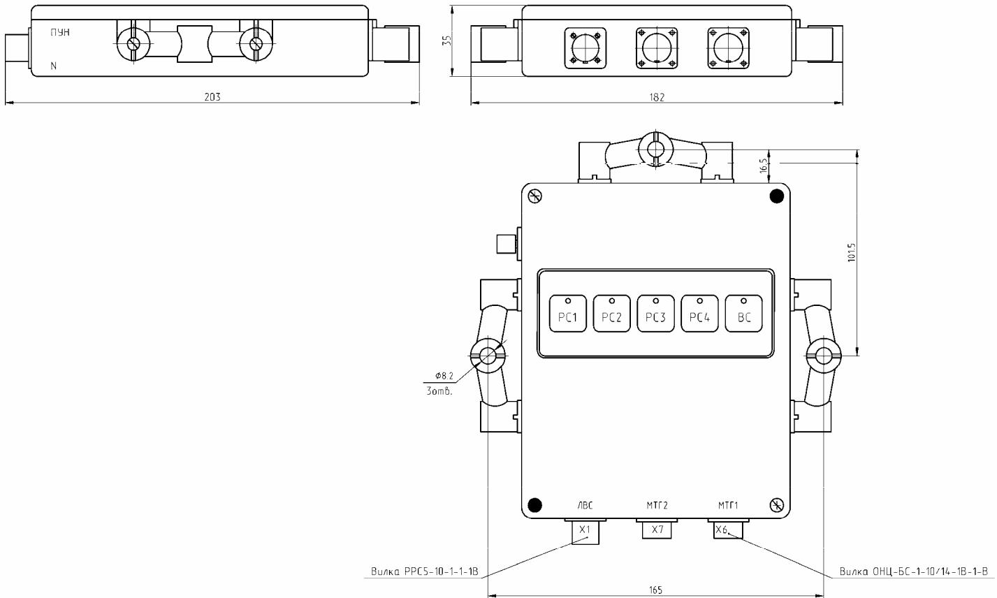
Рисунок 22 - Габаритные чертежи блока управления и индикации ПУН
