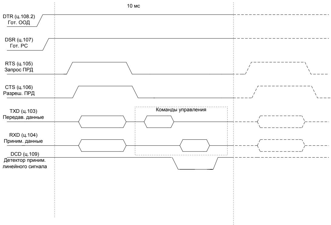
Рисунок Г.3 – Временные диаграммы взаимодействия ООД и РС в многоканальном режиме
