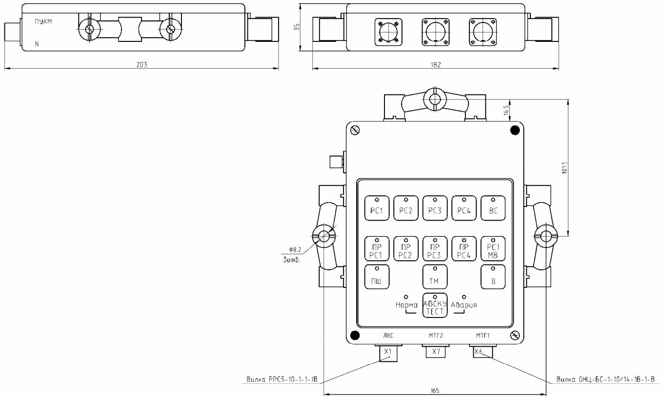
Рисунок 21 – Габаритные чертежи блока управления и индикации ПУКМ
