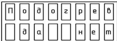
Выбрать кнопками "←", "→" необходимый пункт меню. Нажать кнопку "ВВОД" для установки режима подогрева индикатора. РС готова к работе. Подогрев индикатора включается при температуре окружающей среды ниже минус 10 °C.
