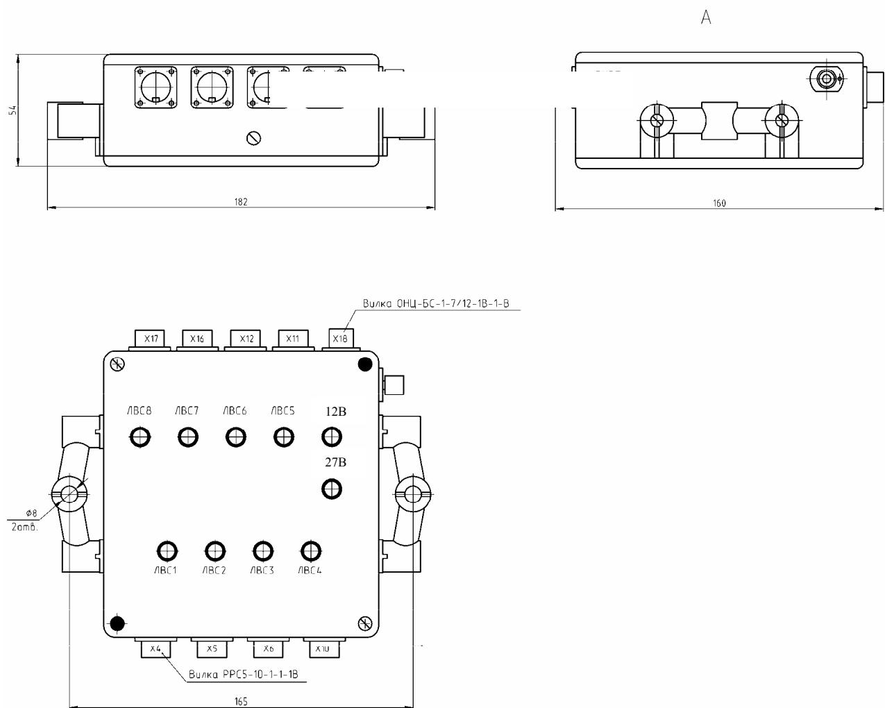
Рисунок 23 - Габаритные чертежи блока коммутации БКБП
