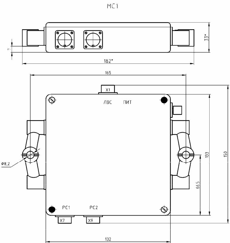
Рисунок 2 – Габаритные чертежи блока сопряжения МС1 ИТНЯ.468351.122
