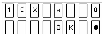
РС начнет сканирование по заранее введенным ЗПЧ (количество ЗПЧ – от 2 до 8), при этом номер ЗПЧ («Х») на индикаторе будет меняться. При приёме тонального вызова сканирование прекращается и РС переходит в режим «ФЧС» на частоте вызова. РС автоматически переходит в режим «СП» через 30 с после последнего приема тон-вызыва или выхода на передачу.
