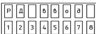
Л.1.7 Подвести маркер с помощью кнопок "←", "→" под нужный номер канала (каналов всего восемь). Нажать кнопку "ВВОД". На индикаторе отобразится меню
