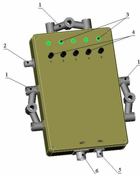
1 – амортизаторы; 2 – клемма заземления; 3 – единичные индикаторы режима работы; 4 – номерные кнопки для управления режимами связи; 5 – соединитель ЛВС (Ethernet); 6 – соединитель МТГ (С1-ТЧ)
