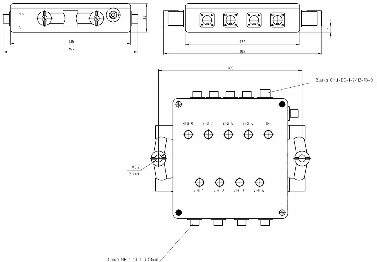
Рисунок 15 – Габаритный чертеж блока коммутации
