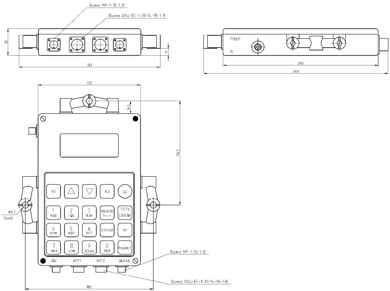
Рисунок 11 – Габаритные чертежи блока управления и индикации ПУДЛ
