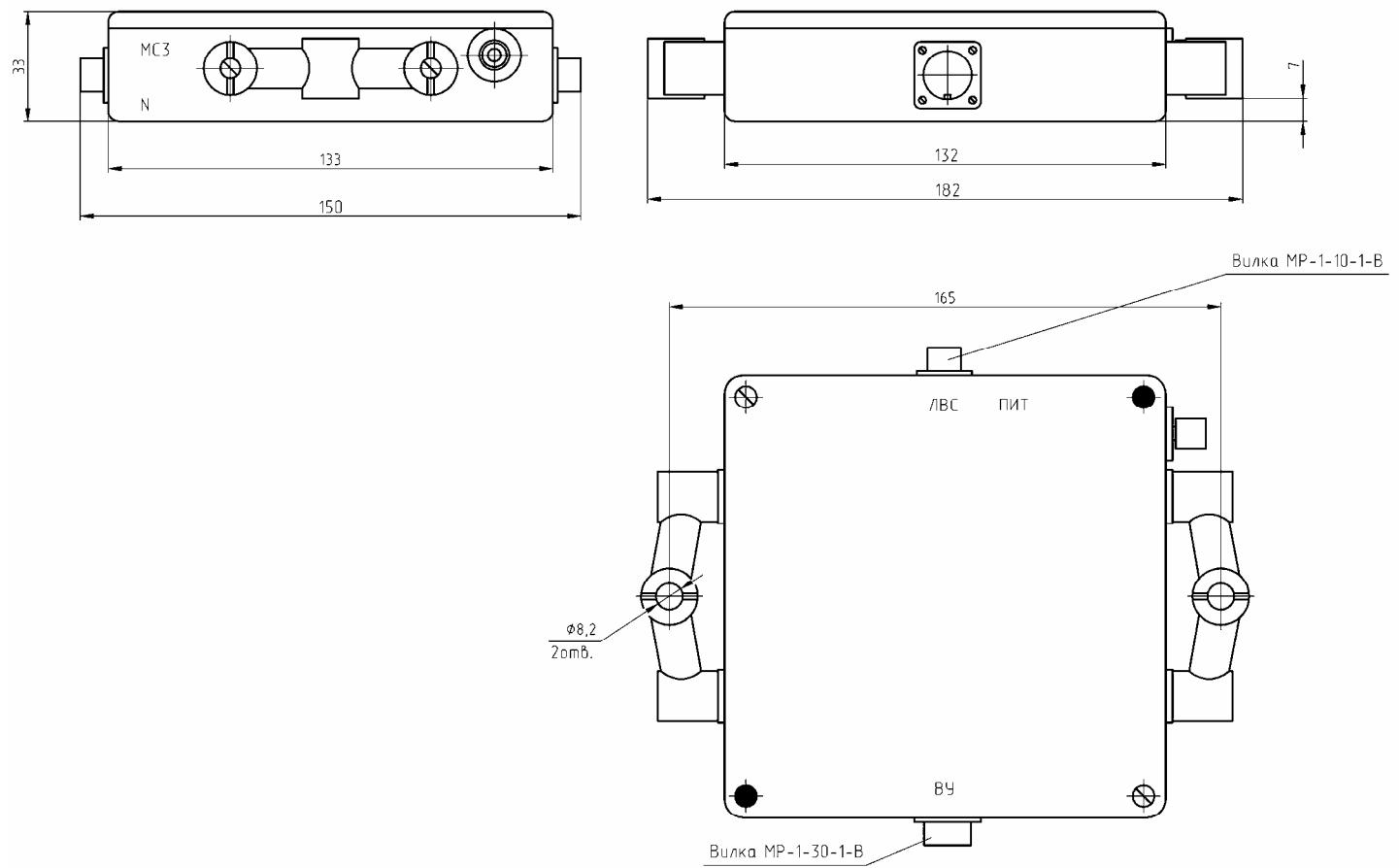
Рисунок 6 – Габаритные чертежи блока сопряжения МС3
