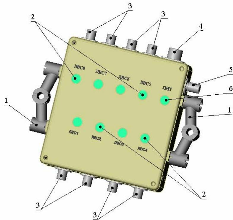
1 – амортизаторы; 2 – индикаторы соединителя ЛВС1-ЛВС8 (Ethernet); 3 – соединители ЛВС1-ЛВС8 (Ethernet); 4 – соединитель ПИТ; 5 - клемма заземления; 6 - индикатор соединителя ПИТ
