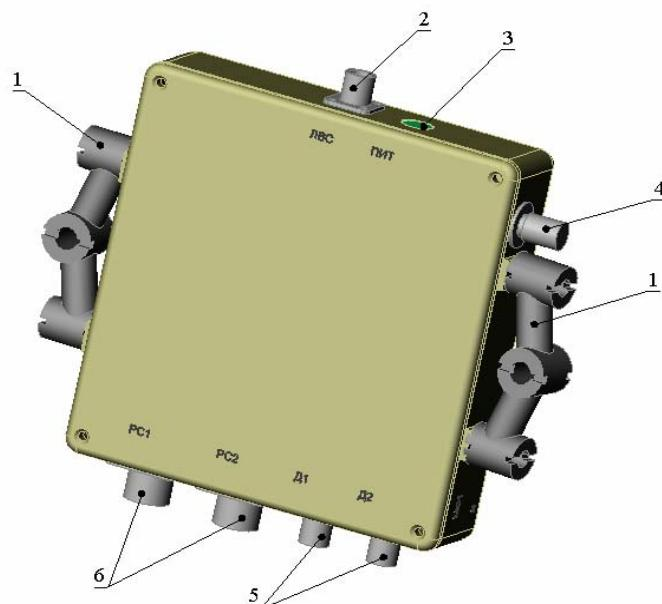
1 - амортизаторы; 2 – соединитель ЛВС (Ethernet); 3 – индикатор включения питания ПИТ; 4 – клемма заземления; 5- соединители Д1 (С1-ТЧ), Д2 (С1-ФЛ); 6 – соединители PC1, PC2 (С1-ФЛ, С1-ТЧ, RS-232C)
