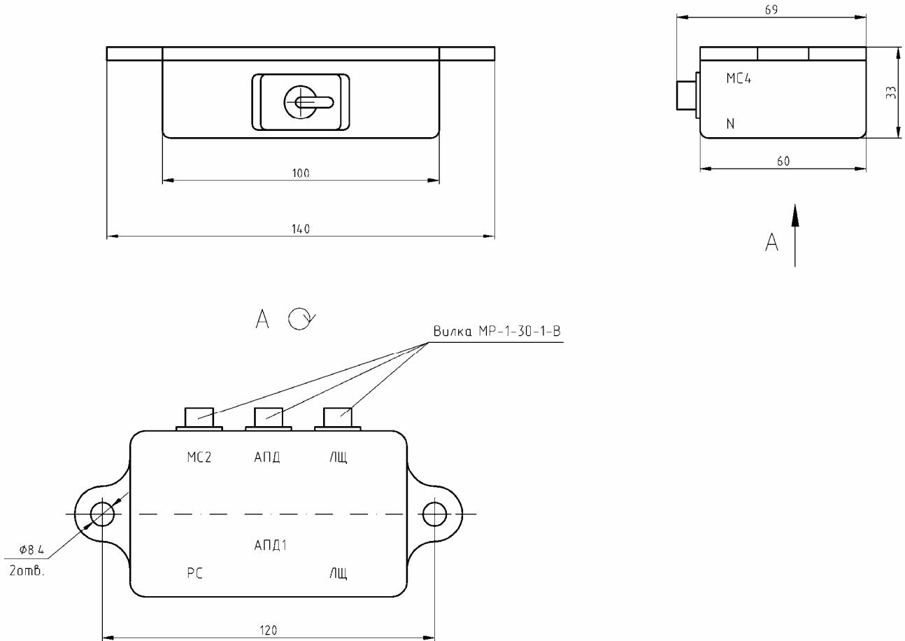
Рисунок 9 – Габаритные чертежи блока сопряжения MC4
