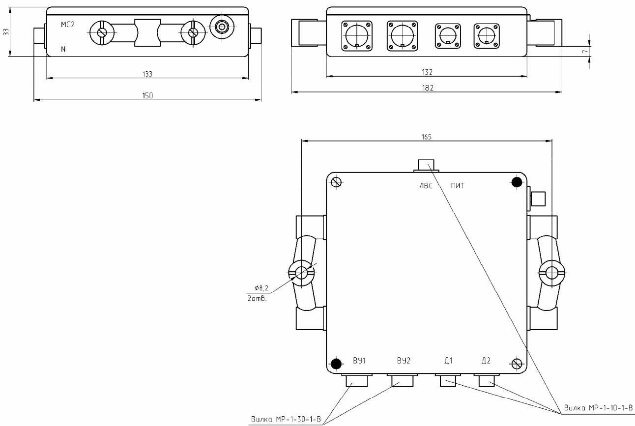
Рисунок 5 – Габаритные чертежи блока сопряжения МС2
