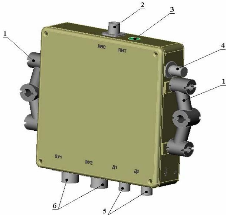
1 –амортизаторы; 2 – соединитель ЛВС (Ethernet); 3 – индикатор включения питания ПИТ; 4 – клемма заземления; 5 – соединители ВУ1 (С1-ФЛ – 2 шт.), ВУ2 (С1-ФЛ – 2 шт.); 6- соединители Д1 (С1-ТЧ), Д2 (С1-ФЛ)
