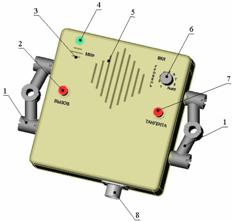
1 – амортизаторы; 2 – кнопка «Вызов»; 3 - микрофон; 4 – индикатор включения питания ВКЛ; 5 - громкоговоритель; 6 - переключатель громкости; 7 – кнопка «Тангента»; 8 – соединитель «МТГ» (С1-ТЧ)
