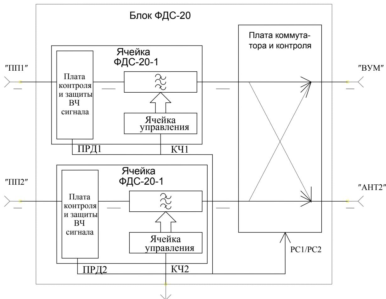
Рисунок 6 - Структурная схема блока ФДС-20
