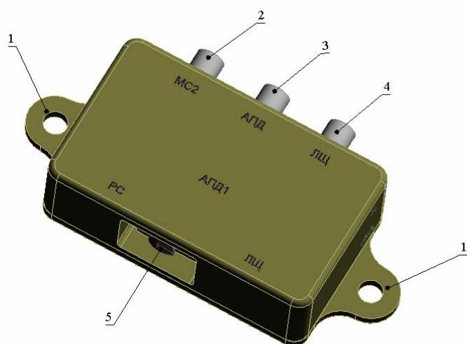
1 – крепёжные отверстия; 2 - соединитель МС2 (С1-ФЛ); 3 – соединитель АПД (С1-ФЛ); 4 – соединитель ЛЩ (С1-ФЛ); 5 - переключатель АПД1 (положение «РС» (С1-ФЛ), положение «ЛЩ» (С1-ФЛ))
