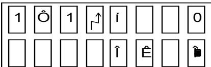
Л.11.2 Для смены ЗПЧ с помощью кнопок "←", "→" подвести курсор к знакоместу номера ЗПЧ и нажать кнопку "ВВОД". На индикаторе отобразится меню (для примера взята частота 45,025 МГц)
