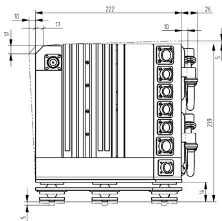
Рисунок Ж.3 – Блок ВУФУС-25 – вид сбоку
