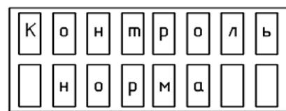
Л.1.2 После самоконтроля РС выходит в режим, в котором она работала перед выключением. РС будет готова к работе после появления на индикаторе основного меню (п.Л.10.1) или по окончании сообщения речевого информатора (если он включен).
