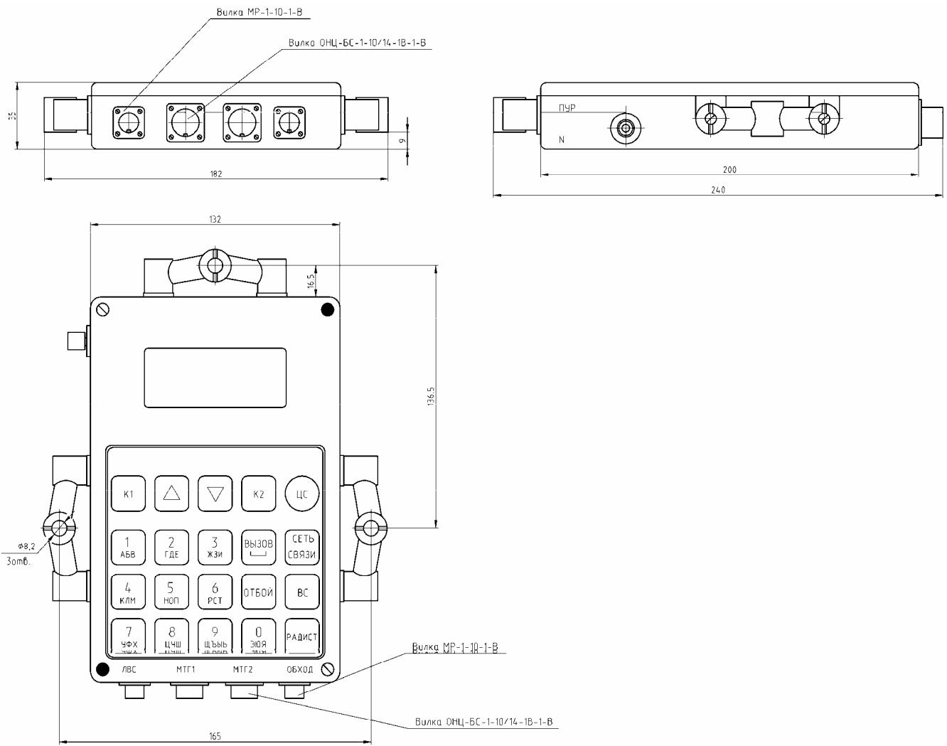
Рисунок 9 – Габаритные чертежи блока управления и индикации ПУР
