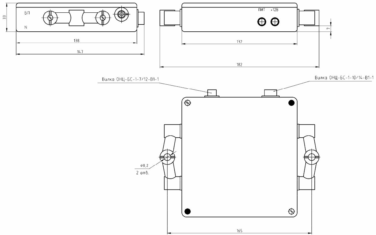
Рисунок 19 – Габаритные чертежи источника вторичного электропитания ИП50В-12-АБ
