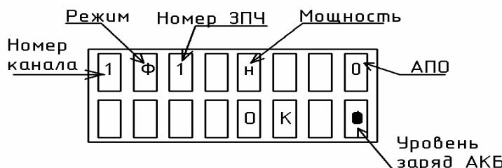
РС готова к работе в режиме «ФЧ» на первом канале первой заранее подготовленной частоты и "низкой" мощности ("низкая" мощность устанавливается по умолчанию).
