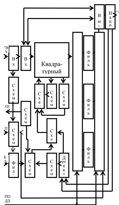
Рисунок 7 - Структурная схема блока УМ-25
