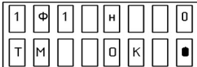
Радиостанция готова к работе в режиме «ФЧ ТМ» на первом канале первой ЗПЧ при "низкой" мощности ("низкая" мощность устанавливается по умолчанию).
