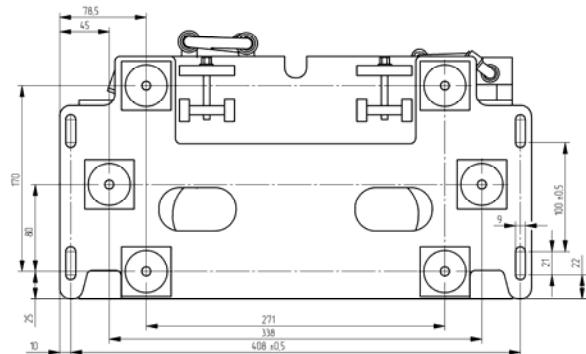
Рисунок Ж.2 – Радиостанция Р-168-25У-2 – вид снизу
