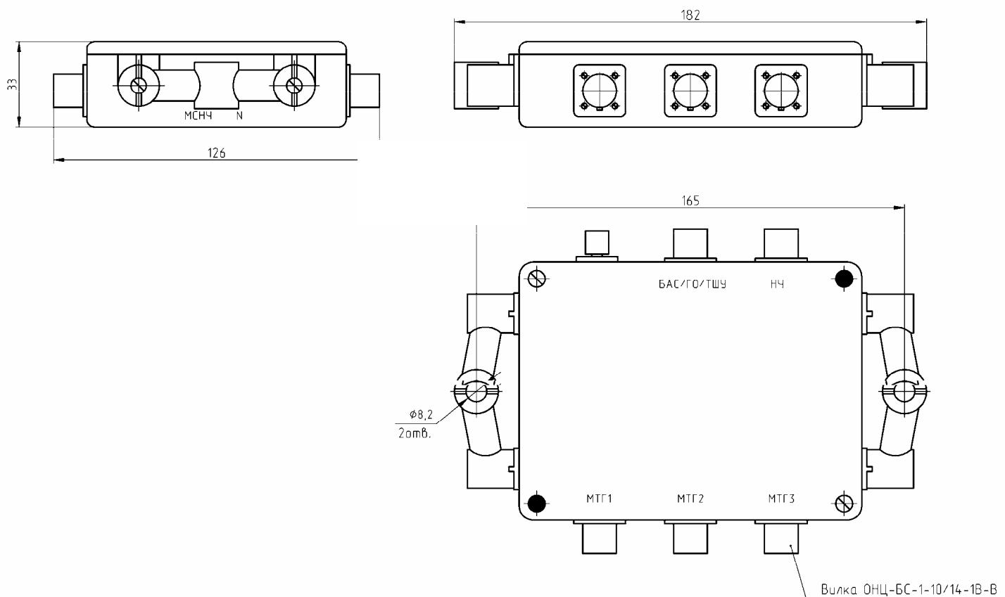
Рисунок 24 – Габаритные чертежи блока сопряжения МСНЧ
