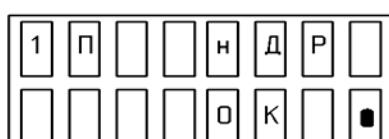
РС готова к работе в режиме ППРЧ на первом канале при "низкой" мощности ("низкая" мощность устанавливается по умолчанию).
