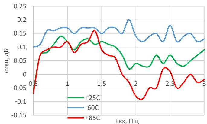
Подавление зеркального канала  $\alpha_{зк}$  ( $F_{вх}$ ,  $P_{гет}$ )
