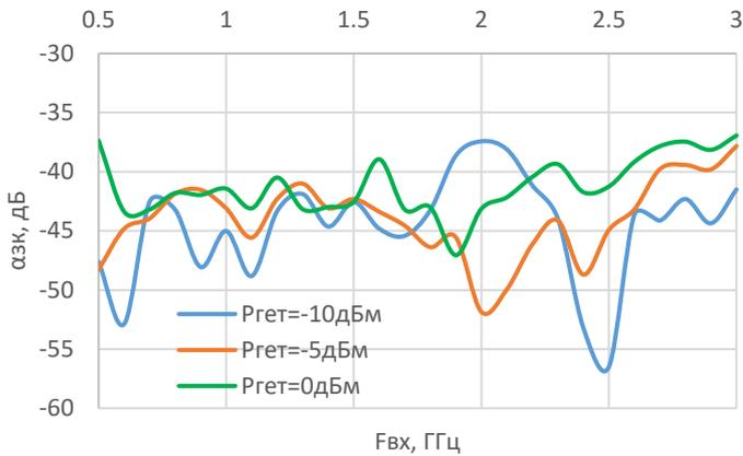
Подавление зеркального канала  $\alpha_{зк}$  ( $F_{вх}$ ,  $T_{окр}$ )
