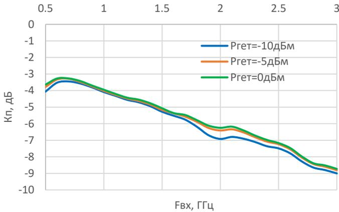
**Коэффициент передачи  $K_p$  ( $F_{вх}$ ,  $T_{окр}$ )**
