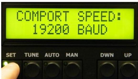
Нажатиями клавиш UP/DWN установить необходимую скорость обмена данными, которая должна быть в точности той, которую использует подключенный трансивер (следует обратиться к Инструкции по эксплуатации трансивера). Подтвердить выбор нажатием клавиши SET. При конфигурировании трансиверов YAESU необходимо установить параметр STOP BIT и подтвердить установку клавишей SET.
