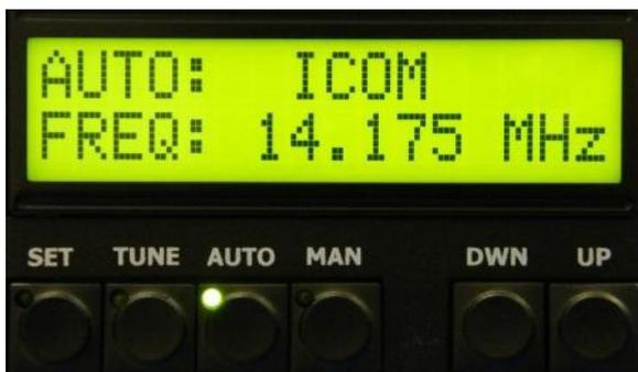
Если трансивер не подключен, либо некорректно установлены параметры коммуникации, на дисплее появится сообщение COMMUNICATION LOST. Можно продолжить использовать усилитель, переключив его в режим ручной настройки MANUAL (клавиша MAN), либо следует устранить корректные параметры коммуникации.
