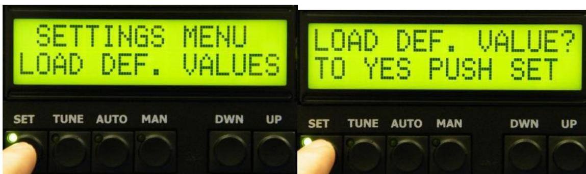
Затем необходимо выбрать между стиранием всех параметров (клавишей TUNE) или одного параметра (клавишей SET). В случае, если вызываются заводские установки одного параметра, клавишами UP/DWN следует выбрать этот параметр и подтвердить клавишей SET.
