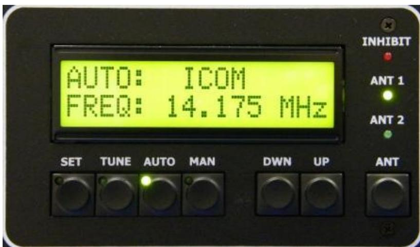
**INHIBIT** - обозначает прерывание работы во время настройки усилителя. Если загорается красный индикатор, усилитель находится в режиме ожидания STBY. В процессе настройки на том же диапазоне усилитель будет подстраиваться в соответствии с частотой трансивера. При смене диапазона загорается индикатор INHIBIT. Он горит, пока даже на короткое время не будет включена цепь KEY IN, чтобы начался процесс настройки. После этого усилитель автоматически будет готов к работе.
